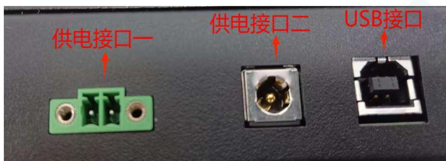
支持 9-32V 电源供电，支持两种供电方式，默认出厂提供 12V 供电电源；
