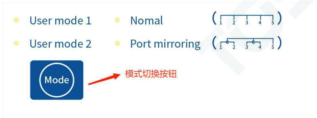
设备通过 mode 键切换工作模式,支持 4 种工作模式:Nomal、Port mirroring、User mode1、User mode2;
