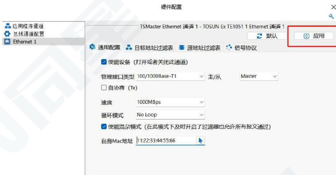
注：需 TE1051 软件配置完成，启动工程后 TE1105 的接口指示灯才会常亮。
