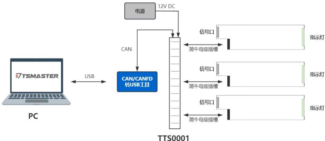
对于总线通讯分析类的板卡，如 TTS1018, TTS1026P, TTS1034, TTS1016 Pro，只需将板卡插入 TTS0001 的插槽（部分设备使用时需要为 TTS0001 供电），通过 TTS0001 上对应插槽的 USB 接口连接电脑即可使用。
