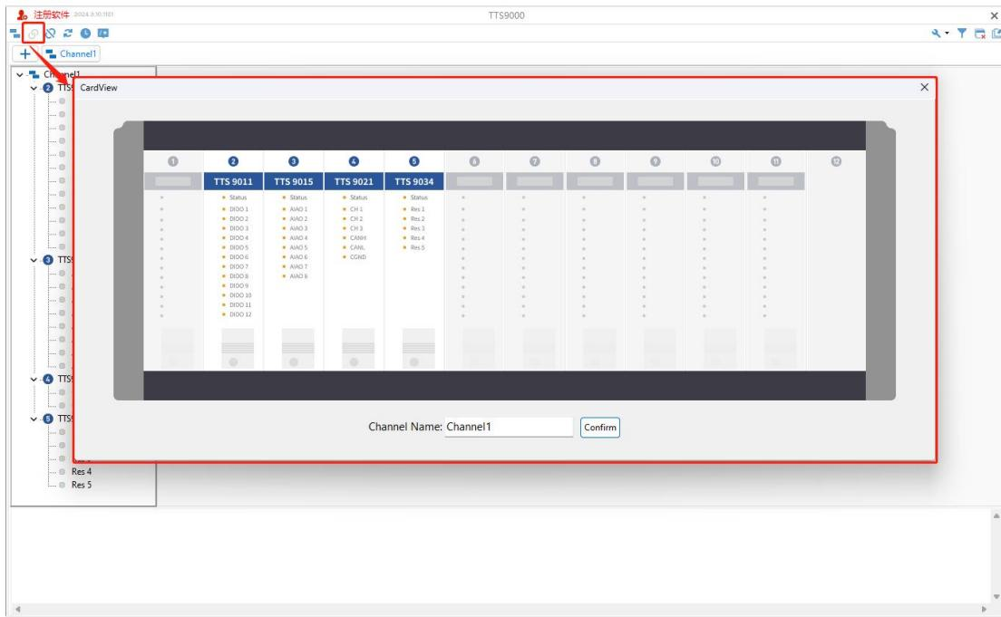
以 TTS9015 为例，实现 1 通道 30V 电压输出的功能，只需在页面中选中 TTS9015 的 1 通道，将通道模式选择为 0-60V 电压输出，再将电压填写为 30V 即可。
