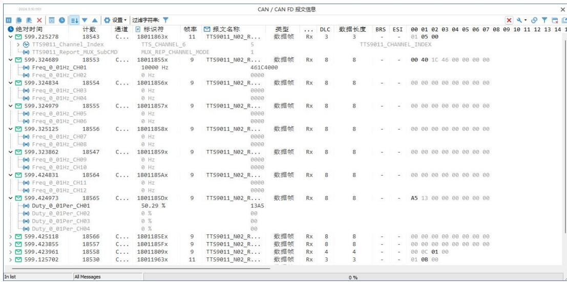
同时在 CAN 数据库中可看到 TTS9011 所有的控制报文，选择并发送报文即可控制板卡执行对应的功能。
