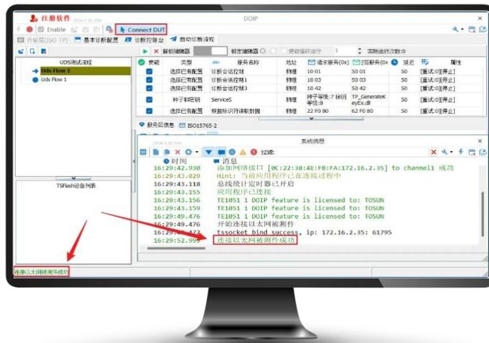
车载以太网诊断协议，Diagnostics over Internet Protocol 简称为 DoIP，可以通过以太网协议进行汽车诊断。DoIP 是一种用于在车辆之间或车辆与诊断设备之间进行通信和诊断的标准协议。通过 DoIP，诊断工程师可以通过以太网或远程访问和诊断车辆的电子系统，并可以进行以太网控制器的诊断访问和刷写。
