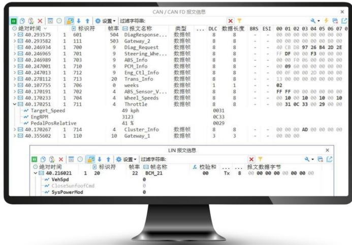
配合 TSMMaster 软件，可实现报文发送/监控/回放、总线统计/记录、数字/图表显示分析等功能。
