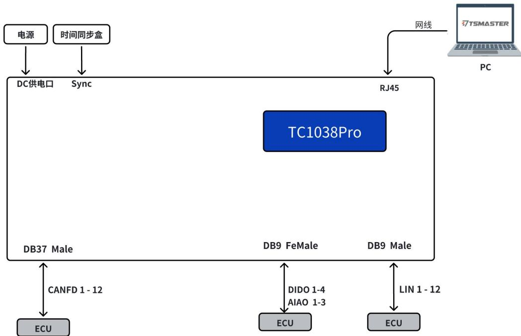
为 TC1038 Pro 通过电源适配器接口或凤凰端子接口 DC 12V 供电，将设备的 RJ45 网线接口连接 PC，客户根据需求，将 CAN/CAN FD, LIN, DIDO, AIAO 对应的接口连接 ECU，即可在 PC 端通过 TSMaster 软件控制 TC1038 Pro 与 ECU 进行通讯。
