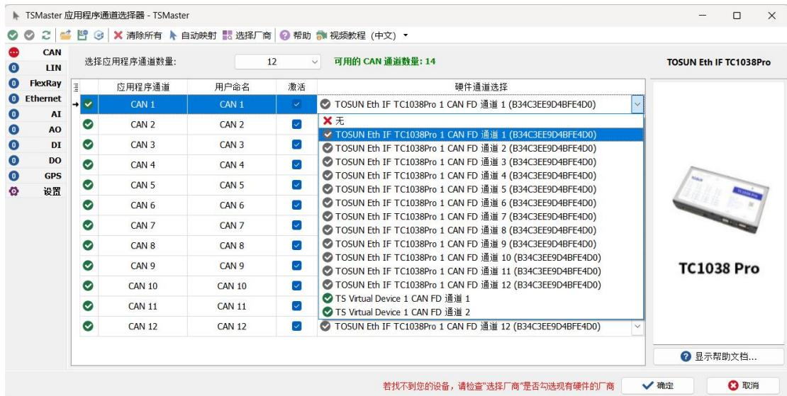
在总线硬件中，可以进行一系列控制器参数的配置，如协议，波特率，控制器模式，终端电阻是否激活等。
