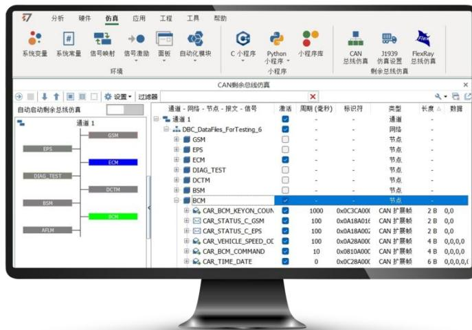
配合 TSMaster 软件，可实现 CAN、LIN 等多总线仿真，以及借助软件 HIL 功能进行 ECU 代码的仿真。TSMaster 内置的 Panel 功能，在面板中可以关联总线信号实现图形化显示。
