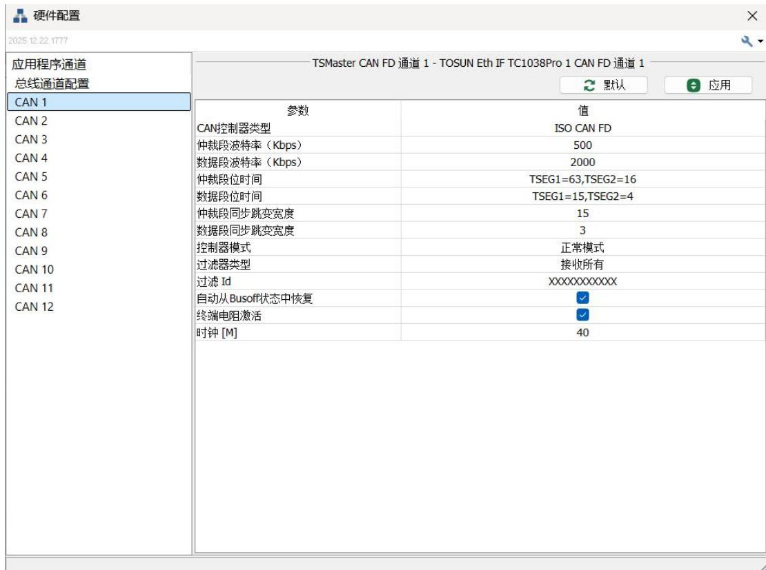
配置完成后，点击启动，连接硬件，即可将硬件配合强大的 TSMaster 工具高效开展总线研发，测试，ECU 产线等多领域的工作。更多 TSMaster 软件的详细使用介绍，可参考 TSMaster 软件手册和快速入门手册。
