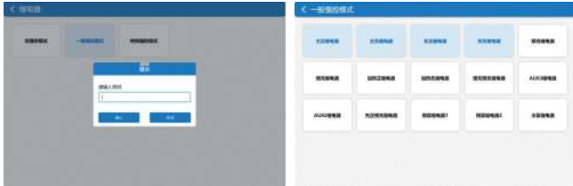
继电器控制模式切换页面 (模式切换需输入密码进行确认) 继电器独立控制页面
