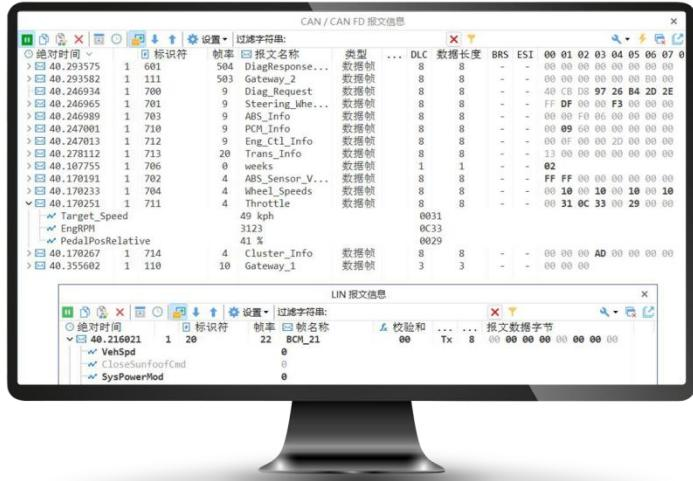
配合 TSMaster 软件，可实现报文发送/监控/回放、总线统计/记录、数字/图表显示分析等功能。
