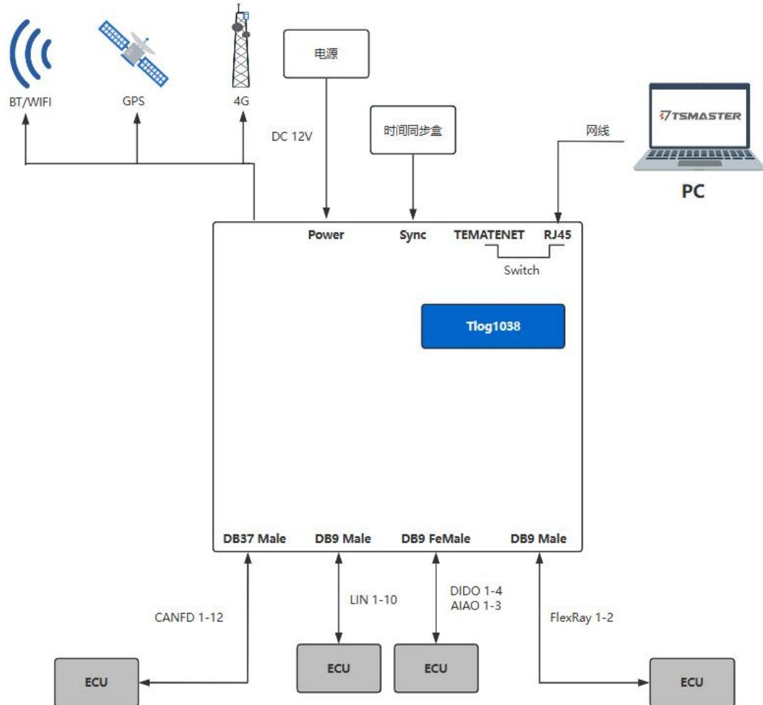
为 Tlog1038 通过电源适配器接口或凤凰端子接口 DC 12V 供电，将设备的 RJ45 网线接口连接 PC，客户根据需求，将 CAN/CANFD, LIN, FlexRay, DIDO, AIAO 对应的接口连接 ECU，即可在 PC 端通过 TSMaster 软件控制 Tlog1038 与 ECU 进行通讯。
