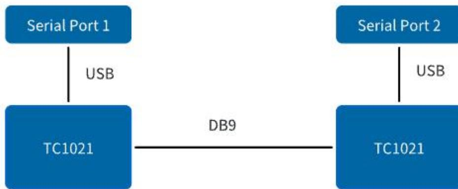
如上示意图所示，将两个 TC1021 通过 DB9 线束连接，两个 TC1021 又通过设备自带的 USB 连接线与串口相连。两个设备之间走 CAN 物理层通信，两设备以外走串口通信。
