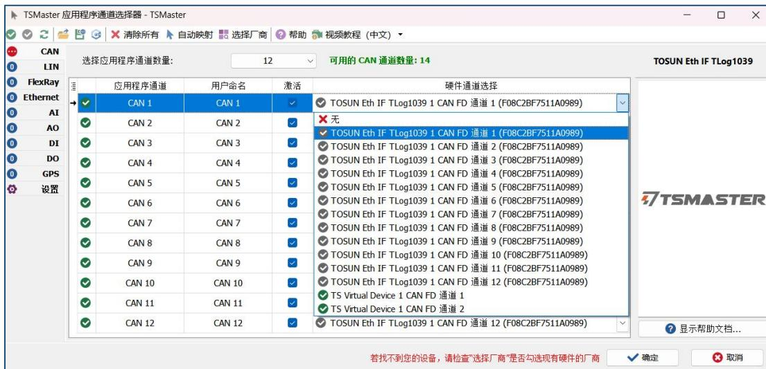
在总线硬件中，可以进行一系列控制器参数的配置，如协议，波特率，控制器模式，终端电阻是否激活等。（Tlog1039 未内置终端电阻，终端电阻激活这一选项可自行忽略。）
