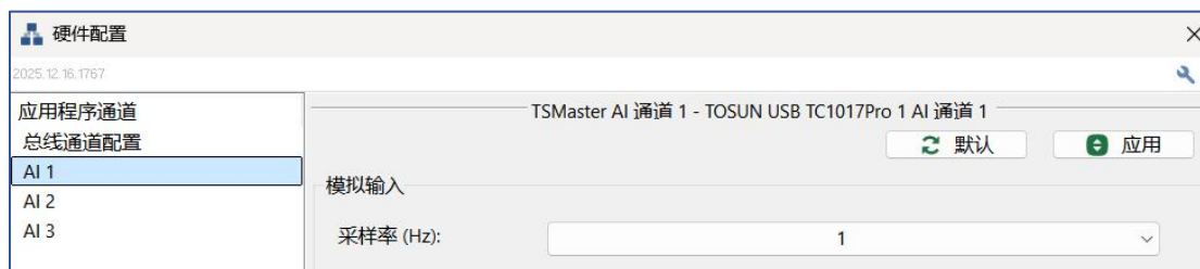
图 2-30 使用硬件配置 AI 参数
