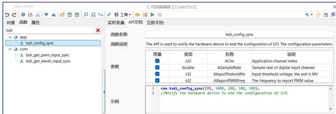
图 2-23 使用 C 小程序配置 DI 参数
