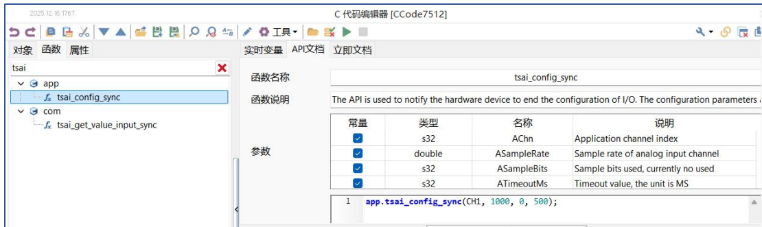
图 2-31 使用 C 小程序配置 AI 参数
